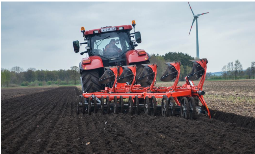
Рис. 3.3 Плуг RW-6 з котком Andpak виробництва Gregoire Besson
