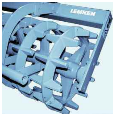
Рис. 3.8 Профіль кулачкового котка VarioPack виробництва Lemken
