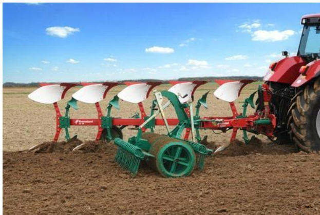
Рис. 3.12 Загальний вигляд плужного агрегату Kverneland з фінішним обладнанням Раскомат
