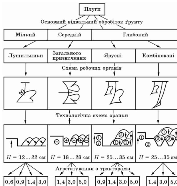
Рис. 3.2 Структурна схема плугів перспективного використання
