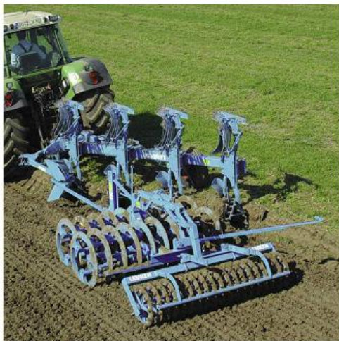
Рис. 3.6 Схема роботи котків VarioPack та FixPack компанії Lemken
