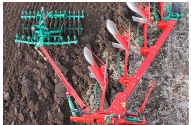
Рис. 3.12 Загальний вигляд плужного агрегату Kverneland з фінішним обладнанням Раскомат
