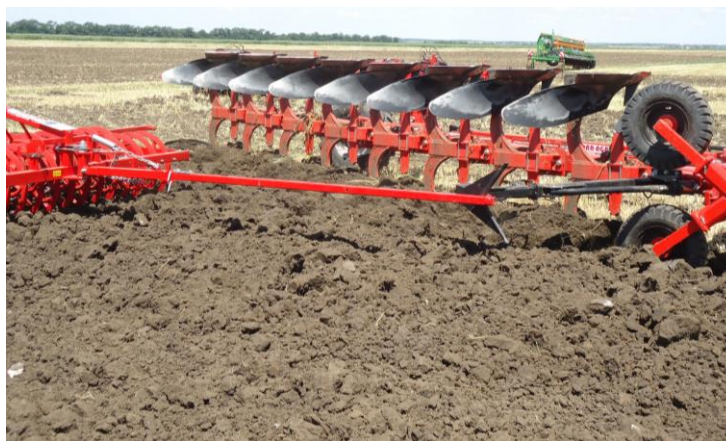
Рис. 3.5 Агрегування котка Dura 700 з плугом
