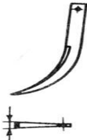
Рис. 3.1 розпушувальні долотоподібні лапи
