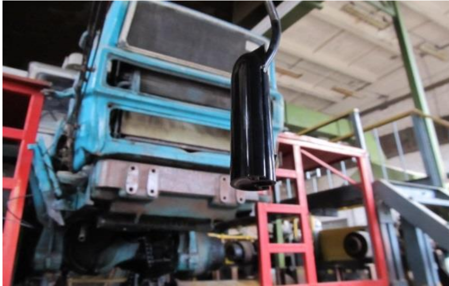
Рис. 3. Установка датчика ПВГП на тракторі Т-150К
