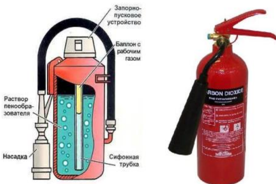
Рисунок 8.1 – Вогнегасник пінний, будова
