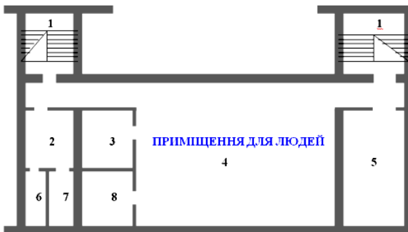
Рисунок 9.1 – Протирадіаційне вбудоване укриття
