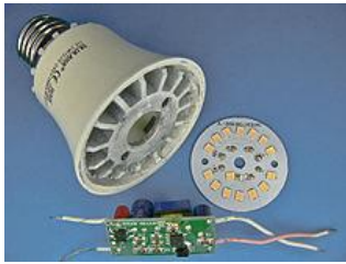
Рисунок 9.2 – Компоненти світлодіодної лампи потужністю 1000 люменів.
