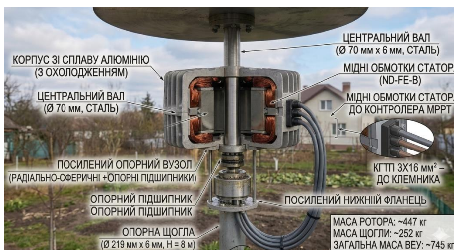
Рисунок 2.3 – Конструктивна схема та внутрішня будова низькообертового генератора Mars Rock G1000 з посиленням опорним вузлом
