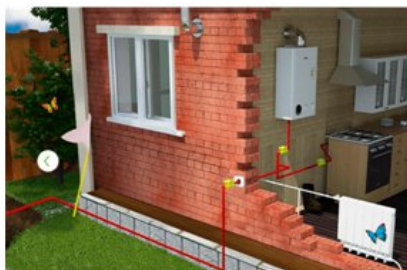
Рисунок 1.1 – Газова автономна система опалення
