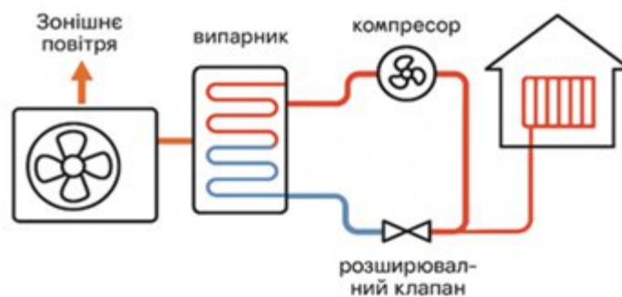
Рисунок 1.7 – Схематичне зображення системи теплового насосу типу «повітря-вода»
