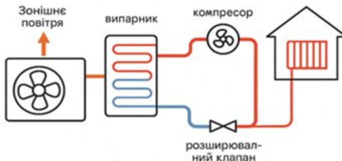
Рисунок 1.7 – Схематичне зображення системи теплового насоса типу «повітря-вода»
