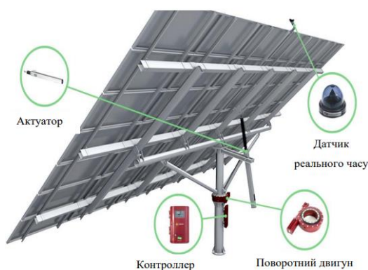
Рисунок 1.3 – Будова сонячного трекера
