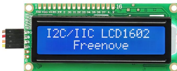
Рисунок 2.8 – Модуль рідкокристалічного дисплея LCD1602A
