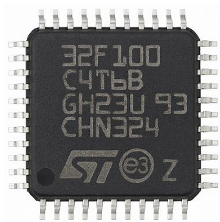
Рисунок 2.6 – Візуальне представлення мікроконтролера STM32F100C4T6B
