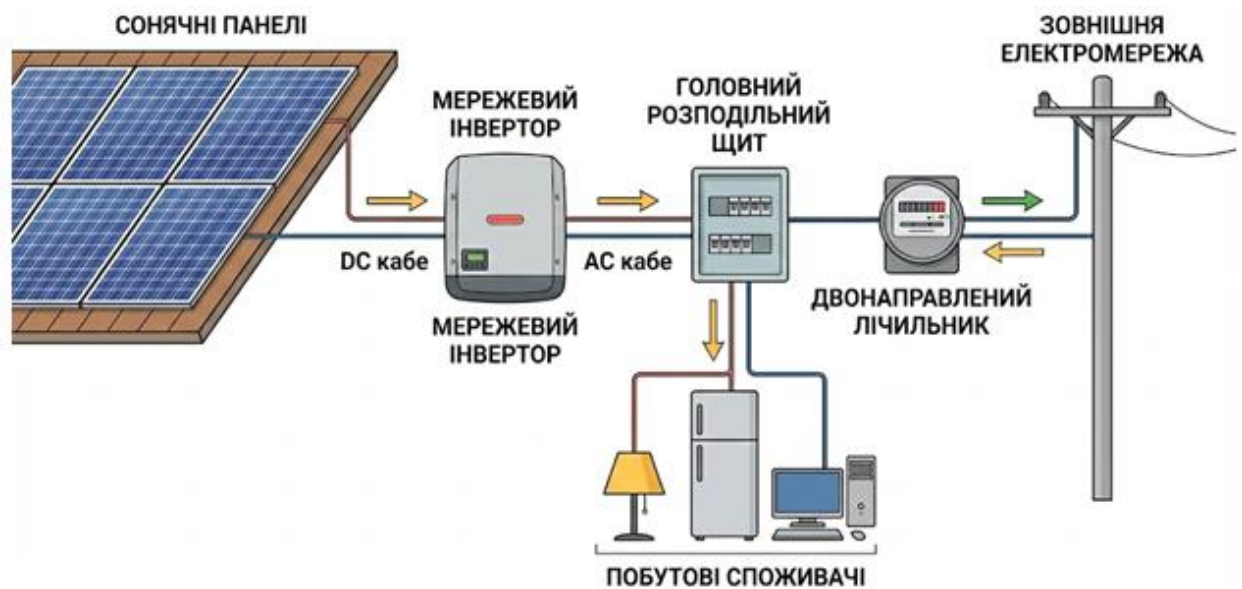
Рисунок 2.4 – Автономна «on-grid» сонячна система
