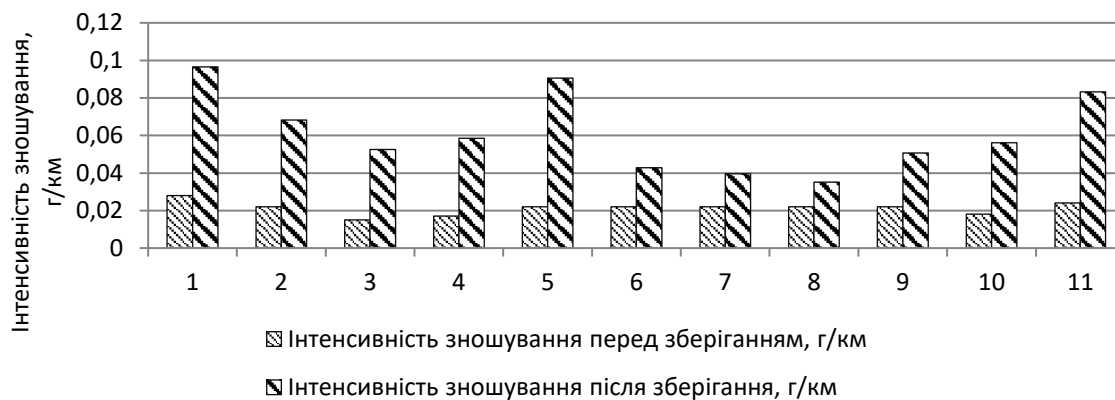
Рис. 3. Інтенсивність зношування зразків сталі, шлях тертя 7488 м (умови зберігання: зона Лісостеп, під навісом з бетонним покриттям, висота розміщення зразків 500 мм на поверхню зберігання):
