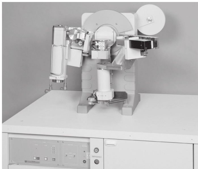
Рис. 3.27. Рентгенівський дифрактометр (зі знятими екранами від рентгенівського випромінювання).
