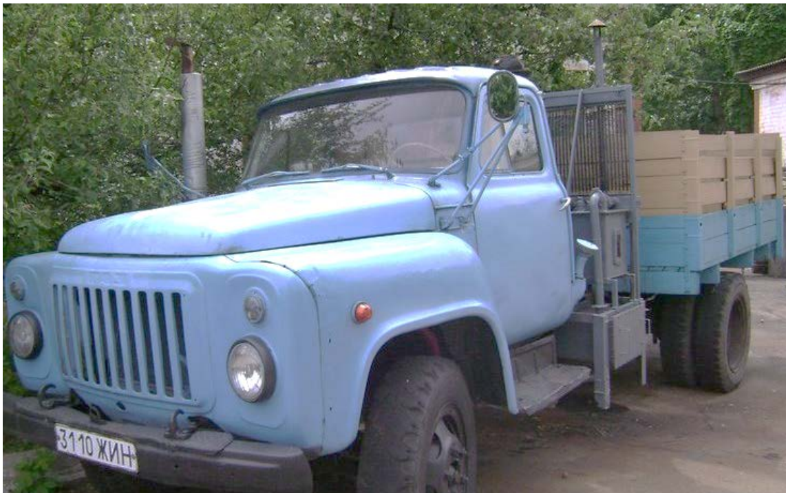
Рис. 1. Автомобіль із газогенераторною установкою розробки вчених ЖНАЕУ (установка розміщена на рамі поза кабіною)
