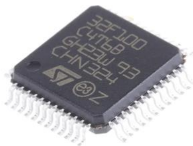
Рисунок 2.6 – Зовнішній вигляд мікроконтролера STM32F100C4T6B
