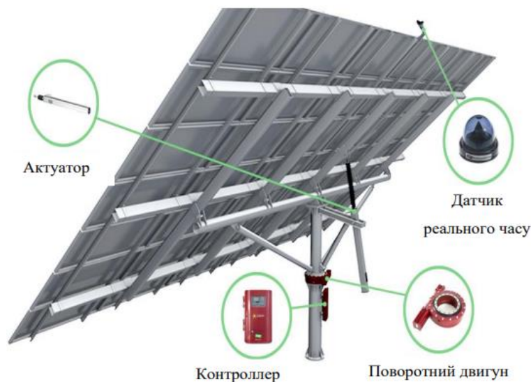
Рисунок 1.3 – Складові частини сонячного трекера
