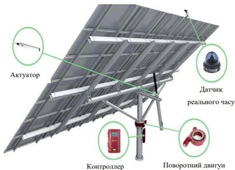
Рисунок 1.3 – Складові частини сонячного трекера
