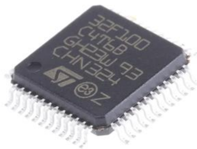
Рисунок 2.6 – Зовнішній вигляд мікроконтролера STM32F100C4T6B
