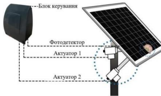
Рисунок 1.4 – Система позиціонування сонячного трекара на фотоприймачах
