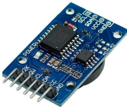
Рисунок 2.11 – Модуль годинника реального часу DS3231
