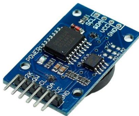
Рисунок 2.11 – Модуль годинника реального часу DS3231
