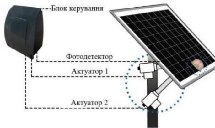
Рисунок 1.4 – Система позиціонування сонячного трекера на фотоприймачах
