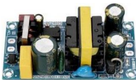
Рисунок 3.12 – Безкорпусний блок живлення
