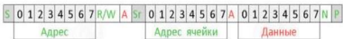
Рисунок 3.21 – Вигляд пакету I2C при зверненні до певного регістру
