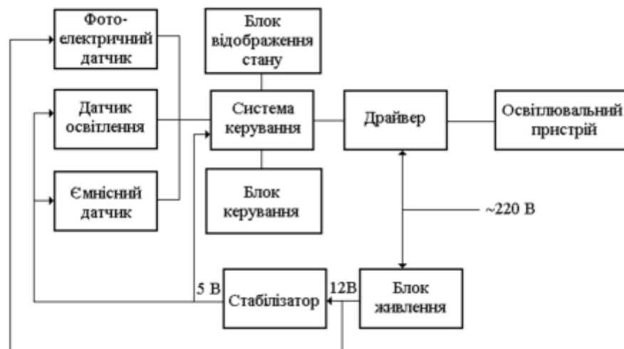
Рисунок 2.4 – Структурна схема автоматизованої енергозберігаючої системи освітлення квартирної приміщення на базі Led-технологій
