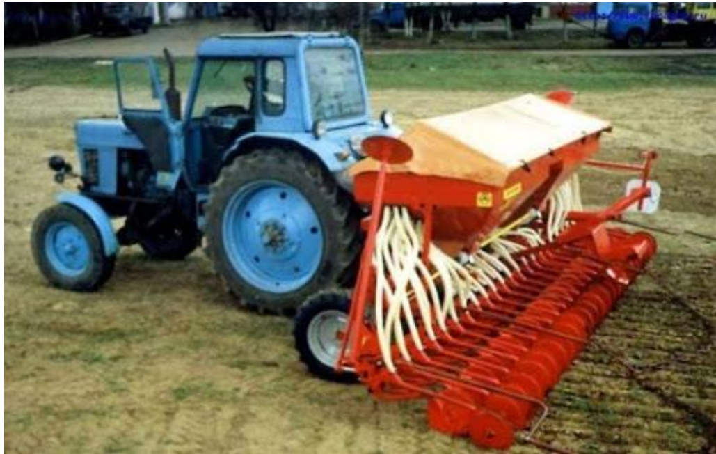
Рис. 2.1. Робота трактора МТЗ-80 з сівалкою універсальною СПУ-6
